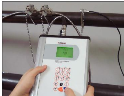
KATflow 230 в качестве теплосчетчика
