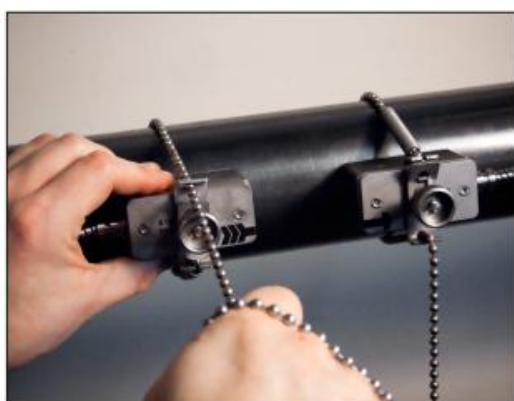
Крепление датчиков при помощи клипс и цепей
